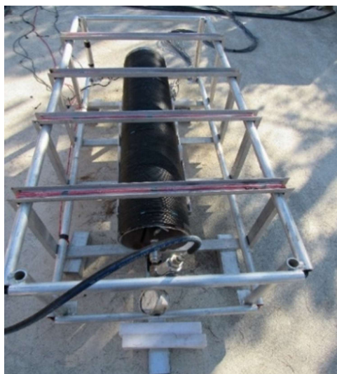
شکل ۱۵ فشارگذاری درون مخزن.
