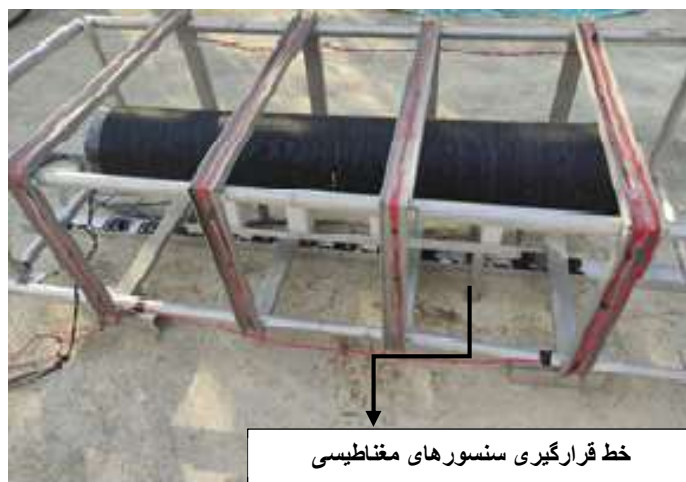
شکل ۱۳ قرارگیری خط سنسورهای مغناطیسی به فاصله ۲۴ سانتی‌متر از کف مخزن.
