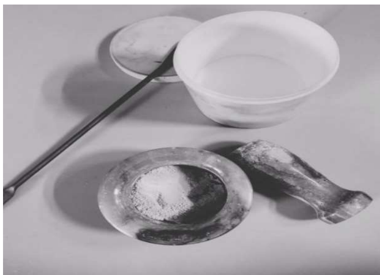
شکل ۲ پودر کردن کائولن و ترکیب با ماده بی اثر.
